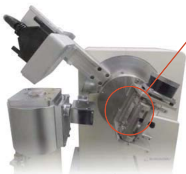
Система измерений макронапряжений на XRD-6100
