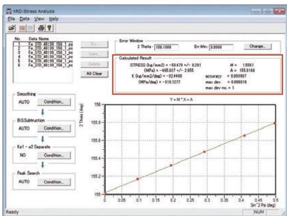
Система измерений макронапряжений на XRD-6100
