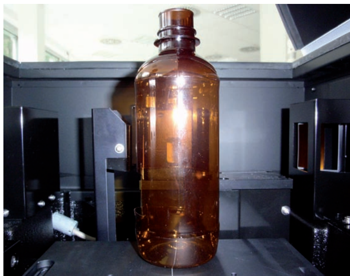
Рисунок 2: Бутылка помещена в многоцелевое кюветное отделение MPC-2600, в положение перед интегрирующей сферой. Окно измерения составляет 1 x 2,5 см. Положение бутылки может регулироваться с помощью столика по направлениям X-Y-Z. Измерительное окно можно увидеть через прозрачную бутылку
