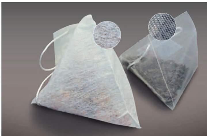
Чайные пакетики в сравнении: целлюлозный без ПЭТ, нейлоновый или полипропиленовый с ПЭТ без целлюлозы
